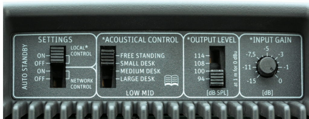
Bedienelemente auf der Rückseite mit den Neumann-typischen Funktionen für definierte Pegelwerte und einem in vier Stufen schaltbaren Desktop-Filter
