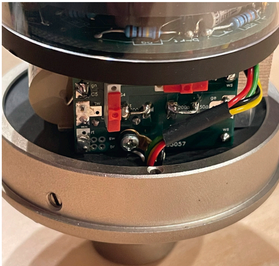
Die internen Schalter S4 (Filter) und S2 (Niere) sind rot markiert
