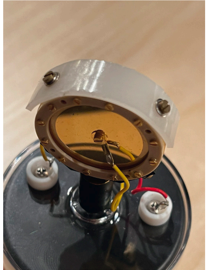
M 49 c Referenzmuster (links) und Vorserienmodell M 49 V. Man sieht die mit einer Kunststoffhaube gedeckelte K47/49 Kapsel
