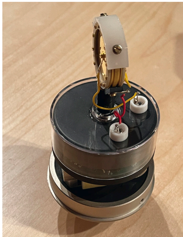
Ein detaillierter Blick auf das Innenleben: Unter der Kapsel liegt die AC701 im M 49 c Referenzmuster quer (links), rechts ist das Innenleben der 1. Etage mit einer Kunststoffhaube abgedeckt. Die NOS-Röhre liegt an der gleichen Stelle quer.
