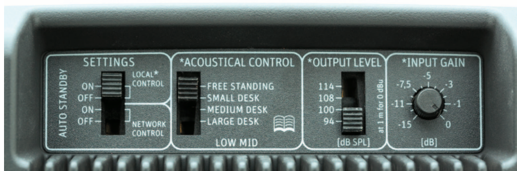
Bedienelemente auf der Rückseite mit den Neumann-typischen Funktionen für definierte Pegelwerte und einem in vier Stufen schaltbaren Desktop-Filter
