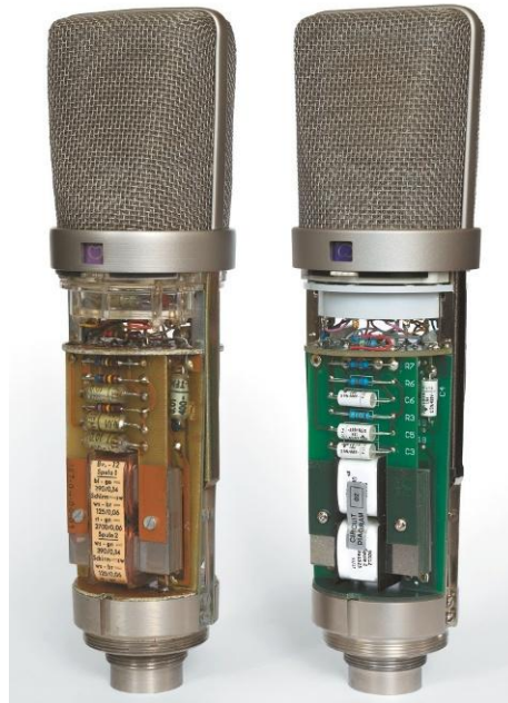
Das alte und neue U 67 im Vergleich: Die Bauteilanordnung ist identisch; in der Neuauflage werden weitestgehend identische Komponenten aus aktueller Fertigung verwendet.
