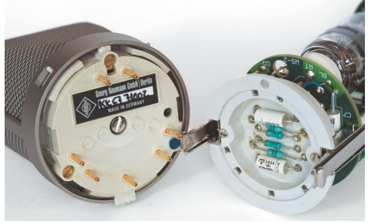
Der Kapselkopf der U-67-Reissue basiert auf dem des aktuellen U 87 Ai, dessen Materialien sich als langzeitstabil erwiesen haben.
