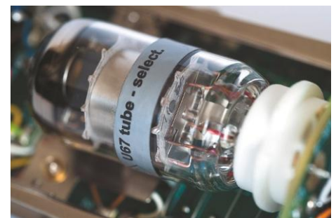
Die Röhre des U 67 ist eine EF86-Type aus aktueller Fertigung ohne Herstellerlabel. Sie wird von Neumann aufwendig selektiert und getestet.
