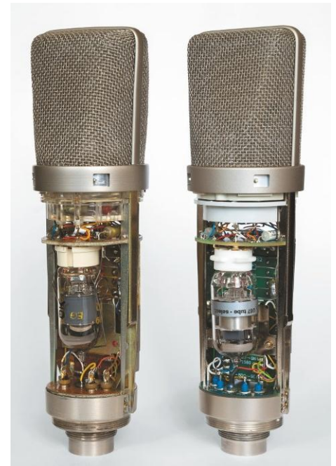
Auch auf der Rückseite keine wesentlichen Unterschiede. Der Haltebügel für die Röhre fehlt bei der Neuauflage, weil man festgestellt hat, dass er keinerlei Funktion hat: Die Röhre sitzt ohnehin fest in ihrem Sockel.
