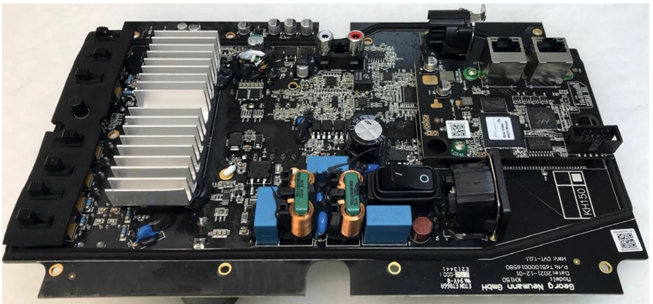
Vorder- und Rückseite des PCB mit der Elektronik des KH 150
