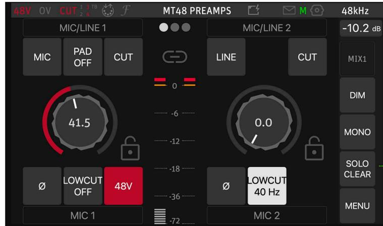
Jeder Vorverstärker verfügt über einen Gain-Regler sowie über mehrere Zusatzfunktionen.
