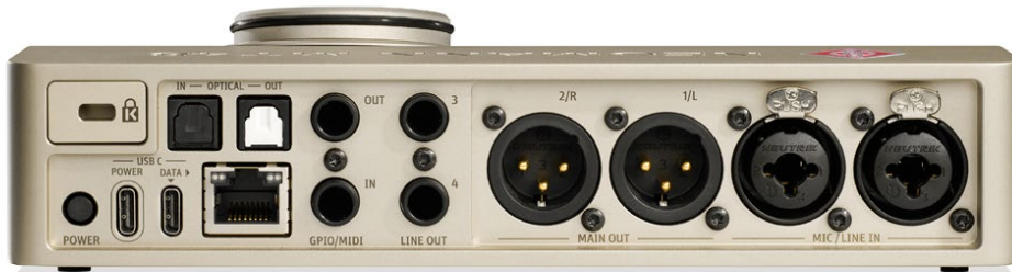
Die Rückseite enthält analoge und digitale In- und Outputs. Es sind zwei separate USB-C-Anschlüsse für Datenübertragung und Stromversorgung integriert. Über die Ethernet-Buchse wird ein AES67/Ravenna-Signal geführt.
